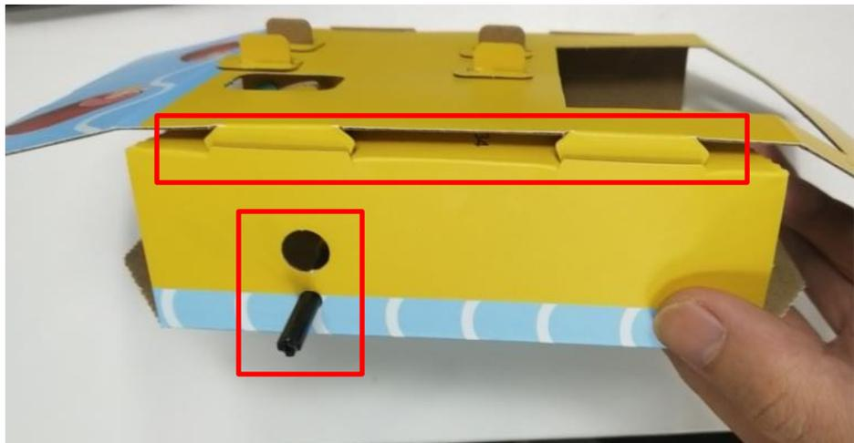
二、将三通线一端连接好机电装置，另一端穿过硬币盒**大的孔位**
