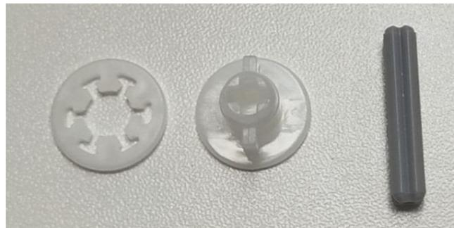
三、把4个凸轮片先进行重叠，并用旋转开关固定，完成后插入短轴
